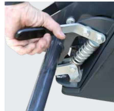
3 Dispositivo per il bloccaggio degli attrezzi azionabile da entrambi i lati.
